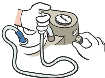
**4** **Verifique a pressão negativa.** Para isso, dobre o tubo de conexão e confira a leitura do manómetro.
