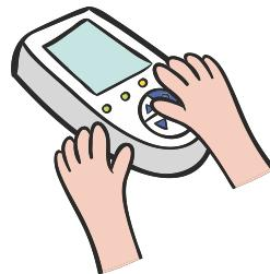
**N**unca poner el monitor sobre un televisor u otro aparato eléctrico que pueda causar interferencias eléctricas (microondas, ordenadores...). En caso de interferencia, utilizar otra toma de corriente si el aparato lo permite.
